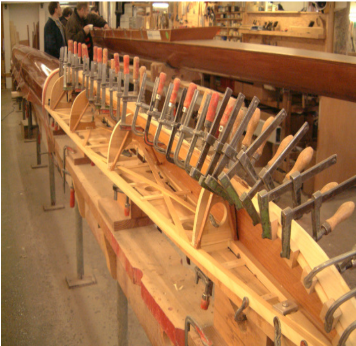
Verleimen der linken Planke mit 40 Zwingen...
